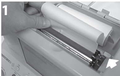
La impresora de palanca está bloqueada en la posición de impresión (abajo).
